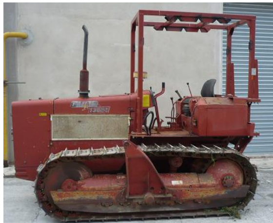
Figura 27. Struttura di protezione per trattori a cingoli modello Fiat 1355 e simili
